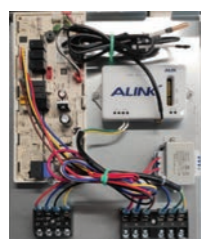
Блок управления QA-TCQ (До 255 фанкойлов) Приобретается отдельно для каждого фанкойла. Внутри блока установлен конвертер QA-Modbus-A.
